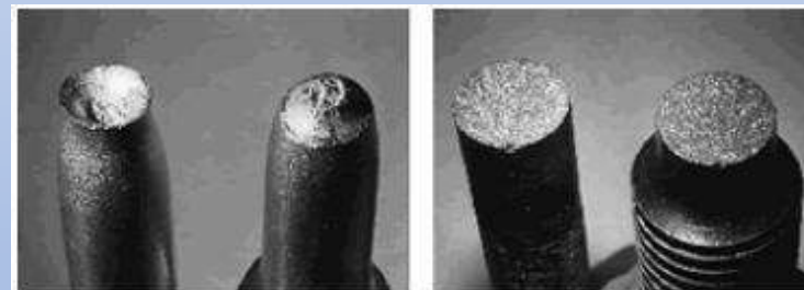
Rottura duttile (materiale tenace)
